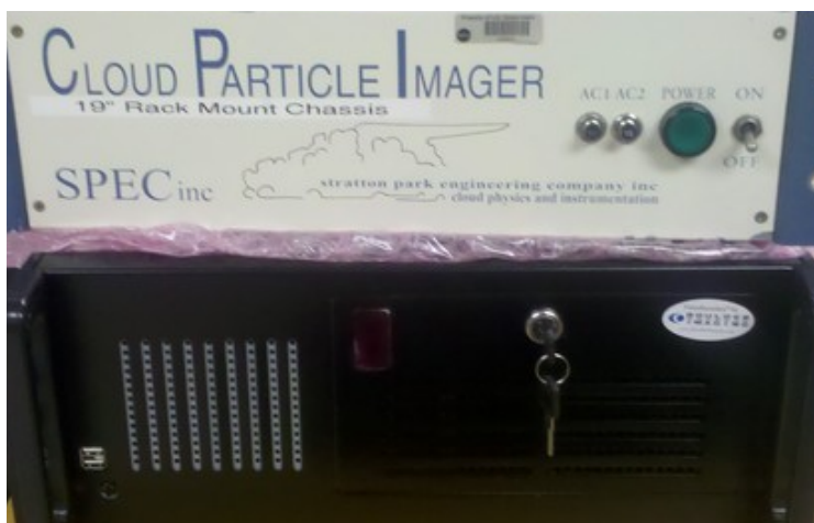
CPI DAS & Control Box
